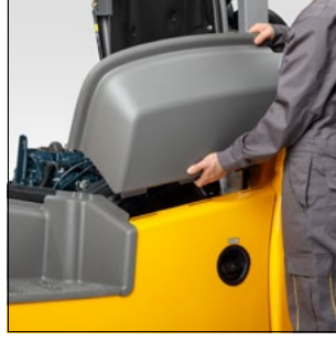
Yan bölümler herhangi bir yardımcı malzeme kullanmadan kolayca çıkarabilir.
