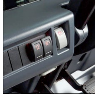
Tek tuşla elektronik olarak kolayca devreye sokulan park freni
