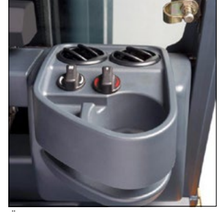
Ön cam için hava ileten kalorifer
