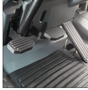
Kaymayı önleyen yüzeye sahip, motorlu taşıtlara özgü pedal düzeni
